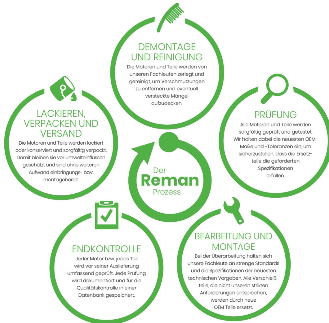
Um die Leistung Ihrer Anlage zu steigern und den Verschleiß zu senken, müssen unsere überarbeiteten Komponenten mit den anderen OEM Komponenten optimal zusammenwirken. Deshalb werden alle reUp Motoren und reUp Ersatzteile von unseren erfahrenen Technikern minutiös überarbeitet und ausführlich geprüft und getestet, um sicherzustellen, dass sie die strengen Standards und Spezifikationen von INNIO erfüllen.
